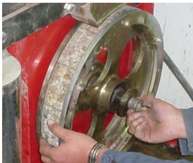
Figura 232 - 7. Instalación de la rueda porta-probetas
