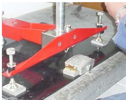
Figura 232 - 8. Probeta colocada en el dispositivo de sujeción
